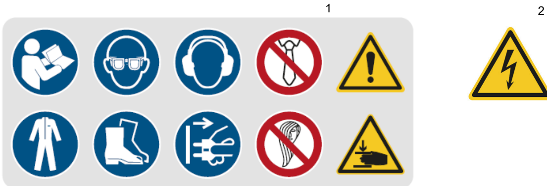
Abb. 1-2: Sicherheitskennzeichnungen - 1 Gebotszeichen: Gebrauchsanweisung/ Betriebsanleitung beachten, Schutzkleidung benutzen, Augenschutz benutzen, Sicherheitsschuhe tragen, Gehörschutz benutzen, Vor Öffnen Netzstecker ziehen, Bedienung mit Krawatte verboten, Bedienung mit langen Haaren verboten, Warnung vor einer Gefahrenstelle, Warnung vor Handverletzungen 2 Warnzeichen: Warnung vor elektrischer Spannung
