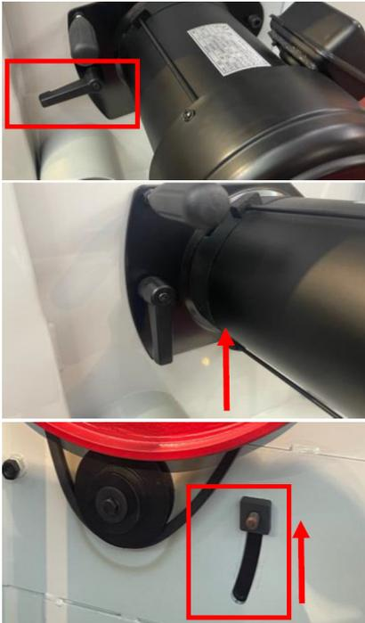
Abb. 17: Klemmschraube lösen
