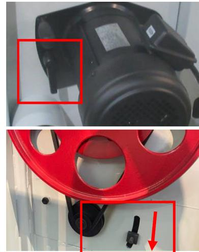
Abb. 19: Klemmschraube lösen
