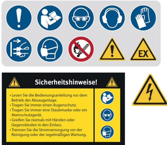
Abb. 1: Sicherheitskennzeichnungen
