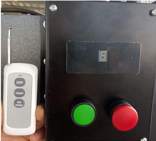
Abb. 13: Betrieb per Fernbedienung
