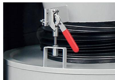
Abb. 11: Schnellverschluss montieren
