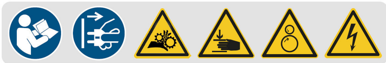
Abb.1-1: Sicherheitskennzeichnungen - 1 Gebotszeichen: Gebrauchsanweisung beachten, Netzstecker ziehen, Warnung vor Einzugsgefahr, Warnung vor Handverletzungen, Warnung vor gegenläufigen Rollen, Warnung vor elektrischer Spannung
