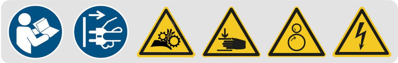
Abb. 1-1: Sicherheitskennzeichnungen - 1 Gebotszeichen: Gebrauchsanweisung beachten, Netzstecker ziehen, Warnung vor Einzugsgefahr, Warnung vor Handverletzungen, Warnung vor gegenläufigen Rollen, Warnung vor elektrischer Spannung
