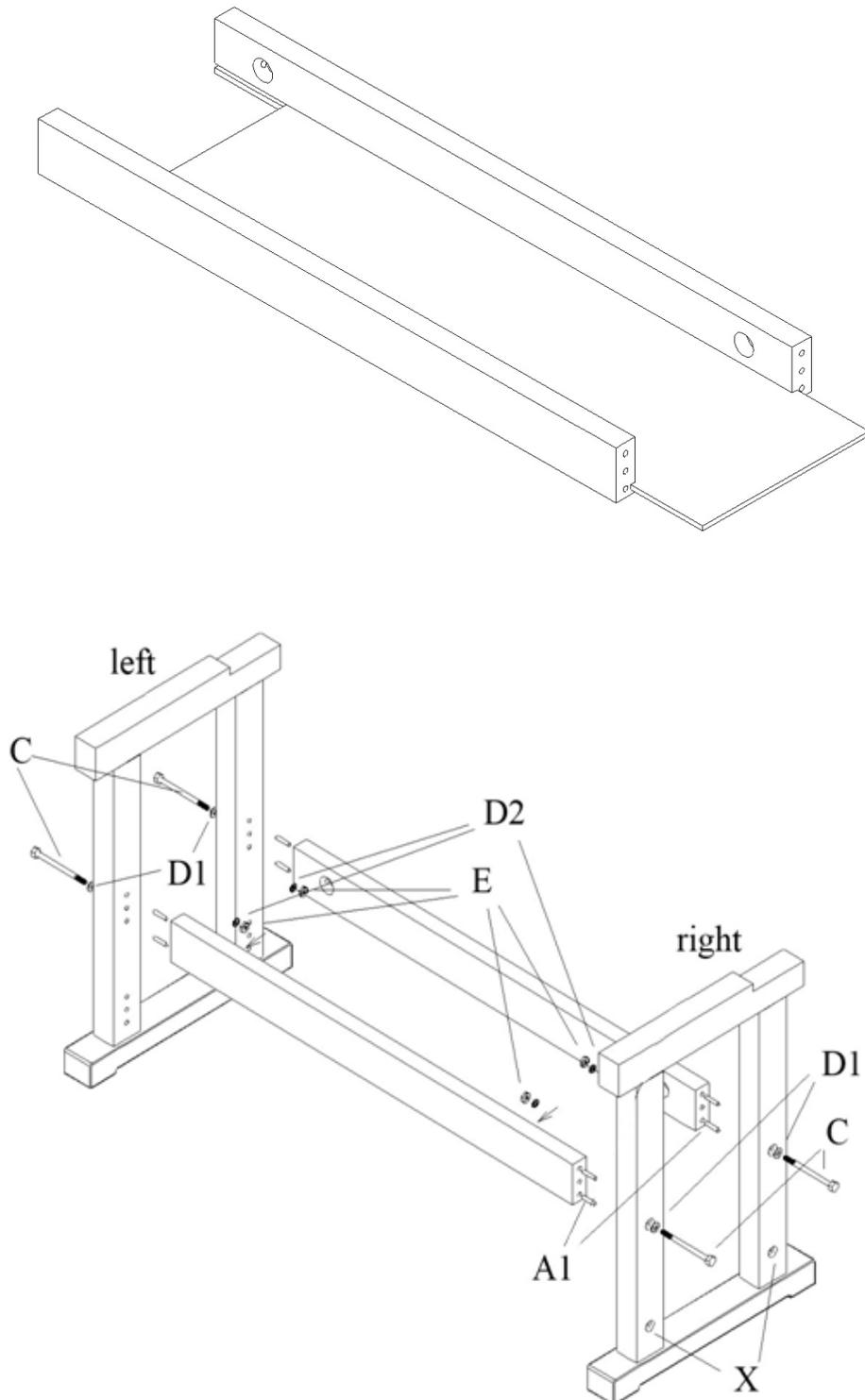
X = Bohrungen für die Querbalken, wenn ein Untergestell verwendet wird!
