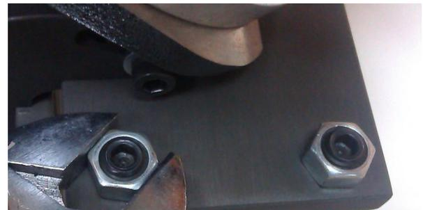
Abb. 19: Klemmmuttern lösen
