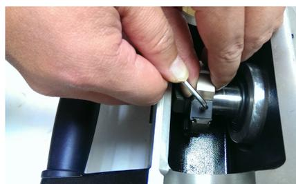
Abb. 15: Schneidplatten abschrauben
