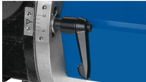
Abb. 13: Klemmhebel zur Befestigung des Führungsaufsatzes
