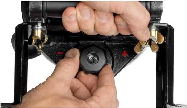
Abb. 5: Drehknopf für die Tiefeneinstellung
