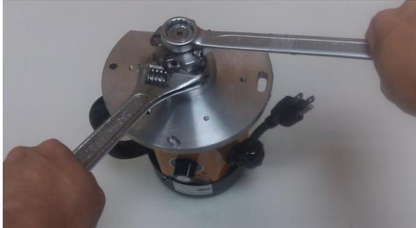
Abb. 16: Fräskopf-Mutter abschrauben
