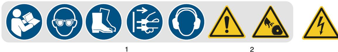
Abb. 1-1: Sicherheitskennzeichnungen - 1 Gebotszeichen: Gebrauchsanweisung beachten, Augenschutz benutzen, Fußschutz benutzen, Netzstecker ziehen, Gehörschutz benutzen | 2 Warnzeichen: allgemeines Warnzeichen, Warnung vor elektrischer Spannung
