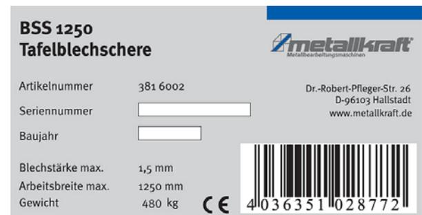
Abb. 2: Typenschild Tafelblechschere BSS 1250 E
