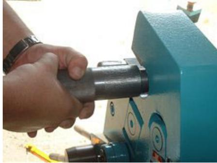
Abb. 15: Verriegelung der Oberwalze lösen
