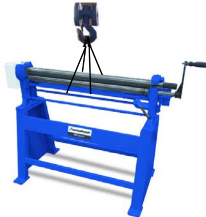
Abb. 4: Transport mit Kran
