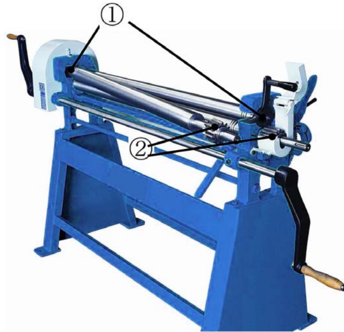
Abb. 16: Zu schmierende Stellen an der Rundbiegemaschine
