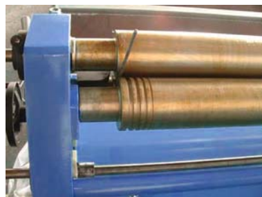
Abb. 8: Parallelität der Walzen prüfen
