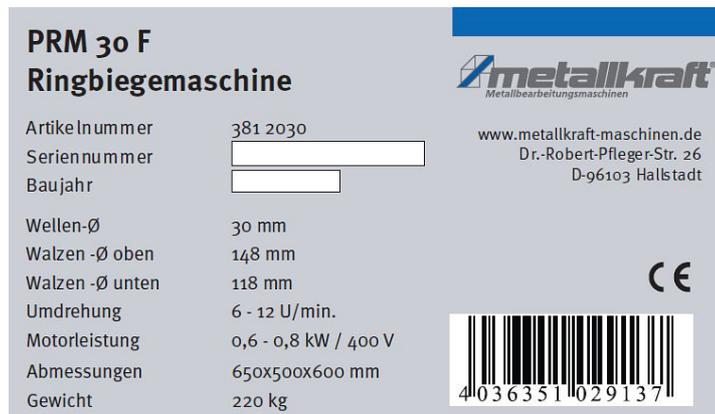
Abb. 3: Typenschild und CE-Kennzeichnung der Ringbiegemaschine PRM 30 F
