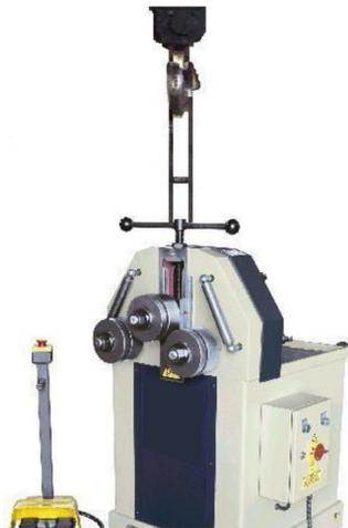
Abb. 4: Ringbiegemaschine transportieren
