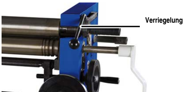
Abb. 5: Verriegelung der Oberwalze lösen
