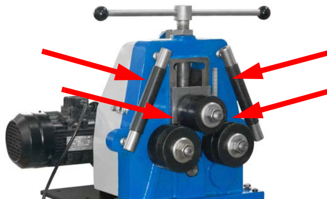
Abb. 8: Gefahrenbereiche an der motorischen Ringbiegemaschine
