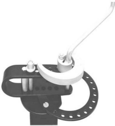
Abb. 37: Biegesegmente für Spiralen
