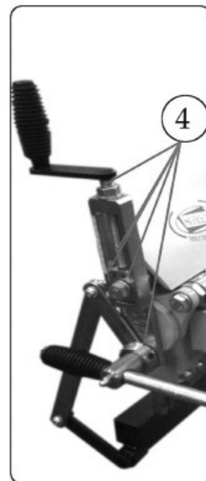
4 Elemente des Hebe- mechanismus der Oberwange - vierseitiges Blechbiegen
