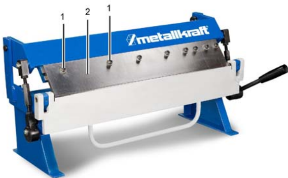
Abb. 5: De-/Montage der Biegesegmente
