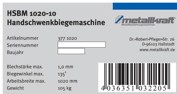
Abb. 2: Typenschild der manuellen Handschwenkbiegemaschine HSBM 1020 - 10
