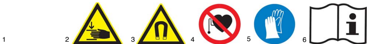
Abb. 1: Sicherheitskennzeichnungen - 1 Warnung vor gefährlicher elektrischer Spannung | 2 Vorsicht Quetschgefahr | 3 Vorsicht starkes Magnetfeld | 4 Kein Aufenthalt für Menschen mit Herzschrittmachern | 5 Schutzhandschuhe tragen | 6 Betriebsanleitung lesen
