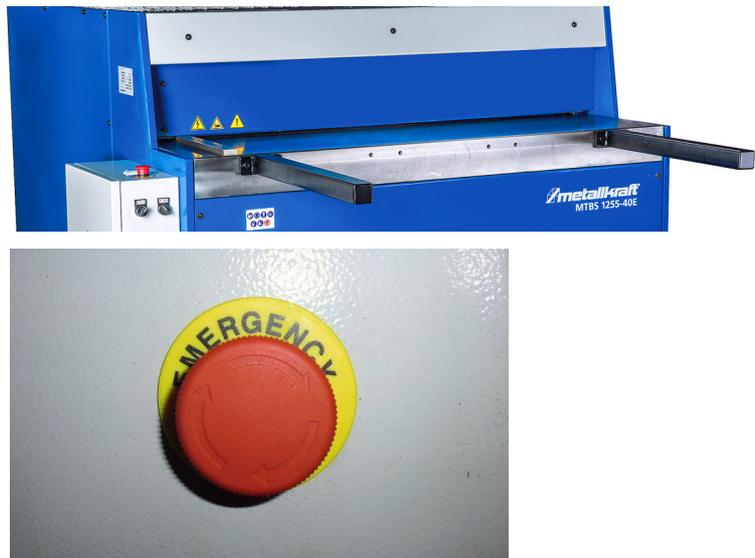
Abb. 2: Sicherheitseinrichtungen an der Maschine
