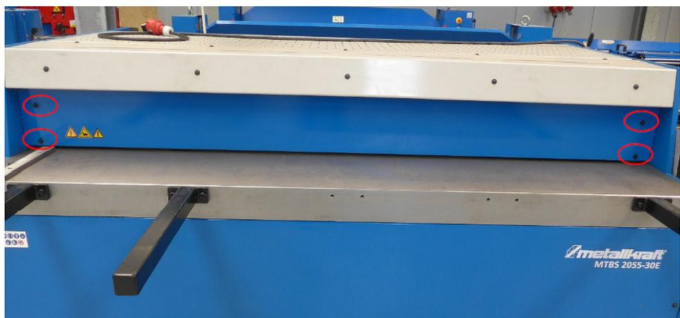
Abb. 18: Demontage mittlere Schutzabdeckung
