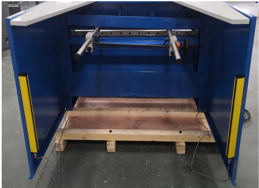
Abb. 6: Blechwinkel über der Materialausgabe, Hinteranschlag, Lichtschranke
