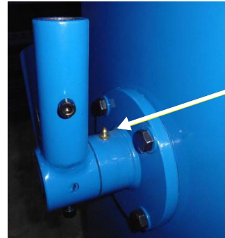
Abb. 7-1: Schmiernippel für Handhebel
