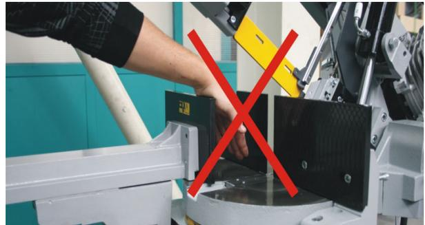
Abb. 5-4:Gefahrenstelle Spannstock
