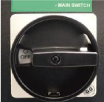
Bevor Sie die Maschine oder ihre Teile einstellen, schalten Sie den Hauptschalter der Schwenkrahmen-Metallbandsäge aus und verhindern, dass andere Personen die Maschine einschalten können.
