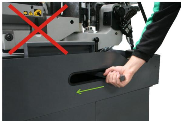
Abb. 5-5: Gefahrenstelle Arretierhebel des Drehtisches
