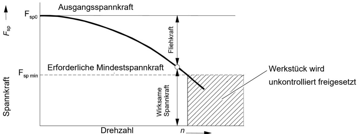
Die notwendige wirksame Spannkraft für die Zerspanung  $F_{sp}$  berechnet sich aus dem Produkt der Zerspanungskraft  $F_{spz}$  mit dem Sicherheitsfaktor  $S_z$ . Dieser Faktor berücksichtigt Unsicherheiten in der Berechnung der Zerspanungskraft.
