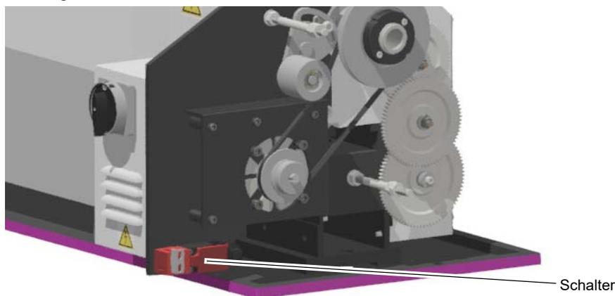
Abb. 1-2: Schutzabdeckung Spindelstock
