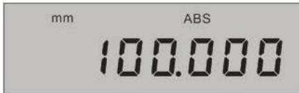
Schritt 1. Prüfen Sie, dass Sie sich im ABS-Modus (absolut) befinden:
