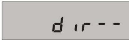
Schritt 2. Drücken Sie
