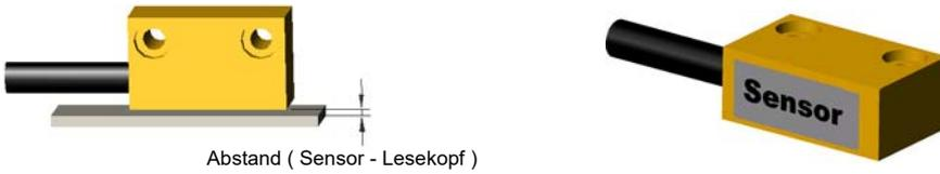
Die Seite mit der Beschriftung " Sensor " muss zum Magnetband.
