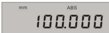
Schritt 1. Überprüfen Sie, ob Sie sich im ABS-Modus befinden: Auf dem LCD sollte ABS angezeigt werden.
