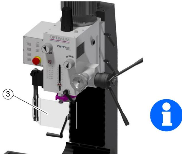
Abb. 1-4: Trennende Schutzeinrichtung
