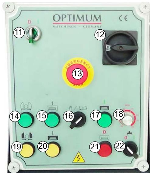
Abb.4-2: Bedienfeld auf der Metallbandsäge
