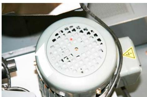
Abb.3-9: Laufrichtung Motor
