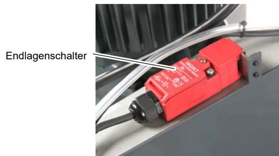
Abb. 1-4: Endlagenschalter/ Schutzabdeckung
