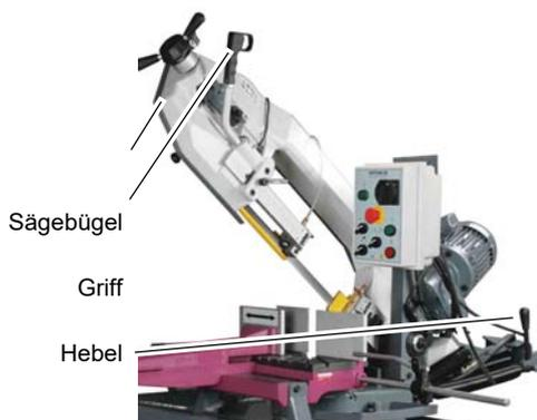
Abb. 4-5: Heben Sägebügel
