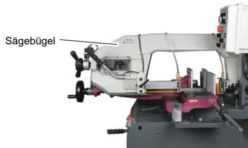
Abb. 1-3: Sägeblattgehäuse mit Schutzabdeckung
