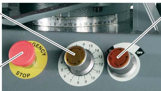
Absenkventil Öffnen (ON)/ Schließen (OFF)
