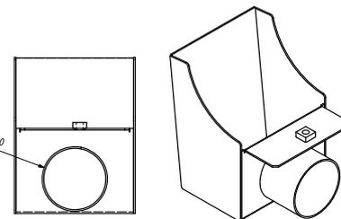
Als Absaugeinrichtung bietet sich der GU2 von Optimum Maschinen Germany GmbH an. Diese Absaugeinrichtung besitzt 60mm Ansaugschläuche, wobei hier beide Absauganschlüsse des Bandschleifers gleichzeitig angeschlossen werden können.
