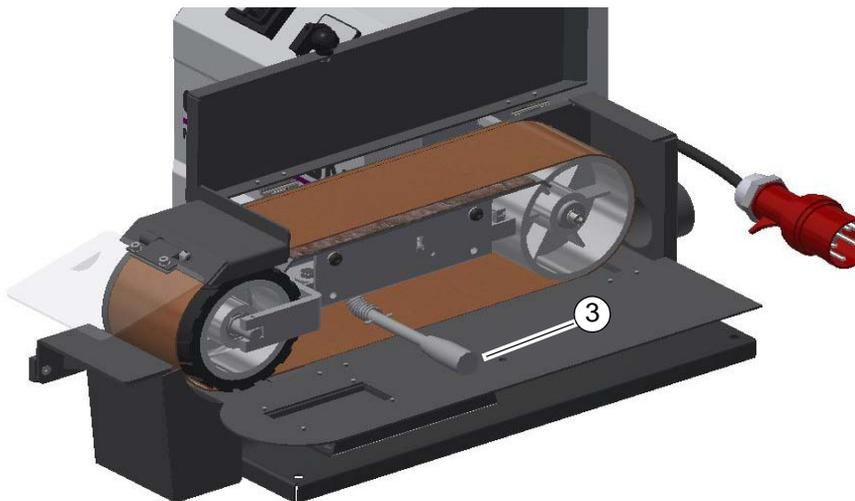
→ Das Schleifband (4) von den Rollen heben und ein neues Schleifband einsetzen.
