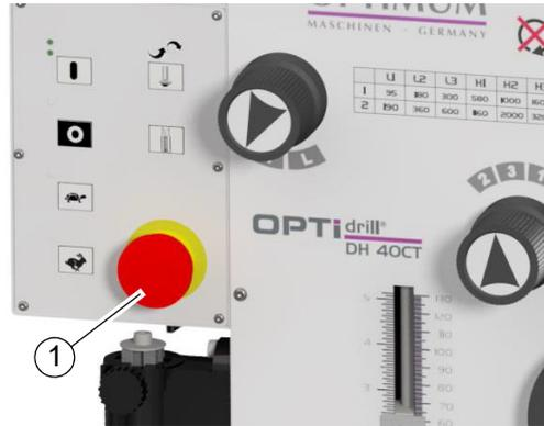
Abb. 1-1: NOT-Halt Schlagschalter
