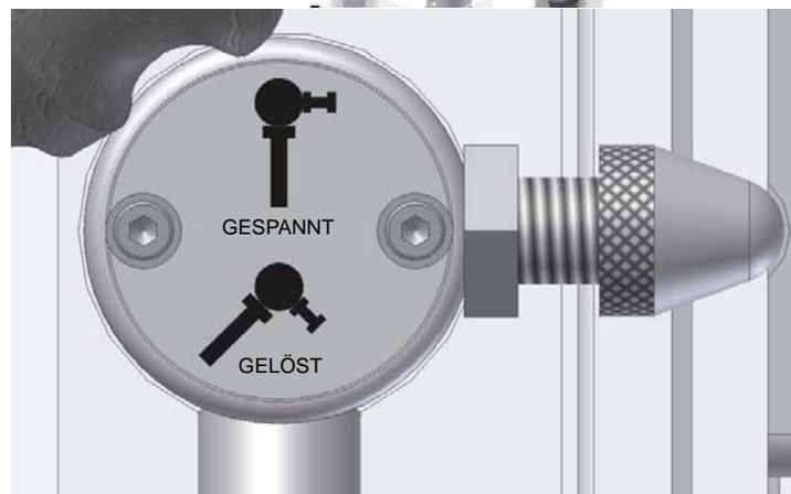
Abb.4-4: Hebel Keilriemenspannung
