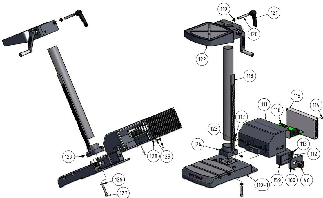
7-6: Säule und Bohrtisch - Column and drilling table
