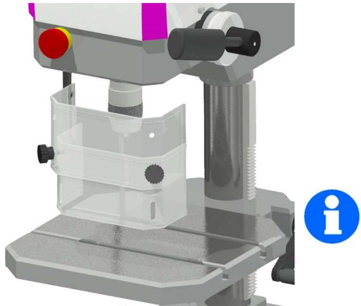
Abb.4-1: Bohrfutterschutz DX15V
