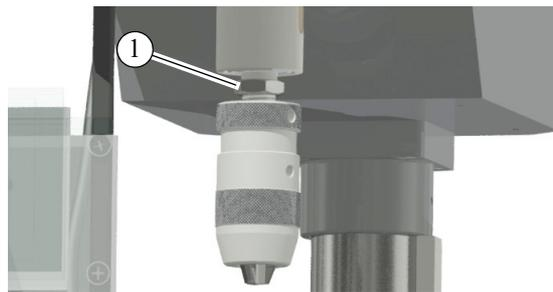
Abb.4-2: Mutter zum lösen der Verbindung DX13V
