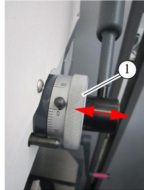
Abb.4-4: Mechanischer Bohrtiefenanschlag
