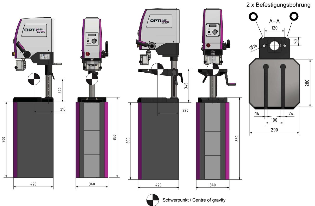
Abb.3-1: Beispiel DX13V | DX15V mit Maschinenunterbau 335 3000
