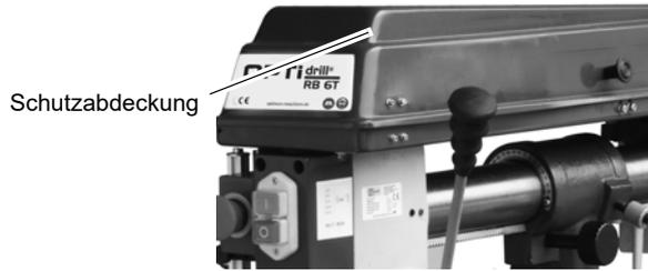
In der Schutzabdeckung ist ein Schalter integriert, der die geschlossene Stellung überwacht.
