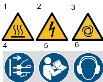
Abb. 1: Sicherheitssymbole am Kompressor: 1 Warnung vor heißer Oberfläche | 2 Warnung vor elektrischer Spannung | 3 Warnung vor automatischem Anlauf | 4 Netzstecker ziehen | 5 Anleitung beachten | 6 Gehörschutz benutzen
