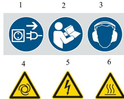
Abb. 1: Gebotszeichen (1 Netzstecker ziehen / 2 Gebrauchsanweisung beachten / 3 Gehörschutz tragen) | Warnzeichen (4 Warnung vor automatischem Anlauf / 5 Warnung vor gefährlicher elektrischer Spannung / 6 Warnung vor Heißer Oberfläche)
