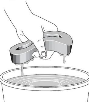
Abb. 8: Reinigung Luftfilter
