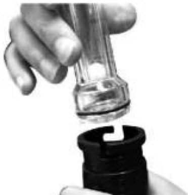
Abb. 16: Einsetzen des Durchflussmessers
