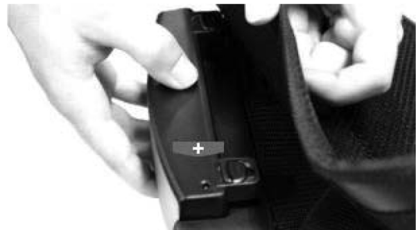
Abb. 31: Einbau des Akkus
