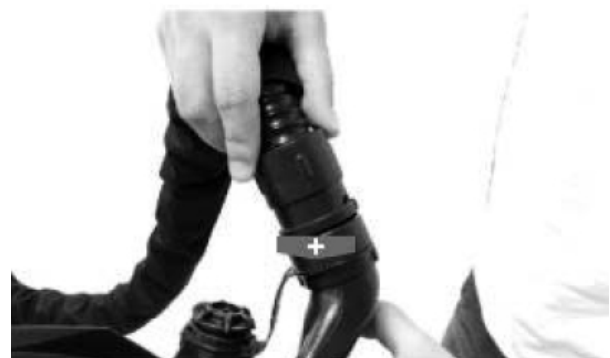
Abb. 19: Demontage des Schlauchs an der Helmseite
