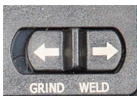
Abb. 6: Wahlschalter für die Betriebsart
