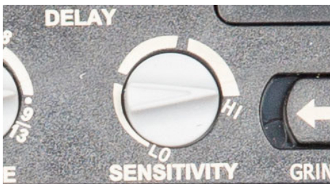
Abb. 5: Einstellung der Empfindlichkeit
