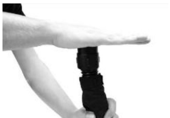
Abb. 19: Test des Luft-Fluss-Alarms
