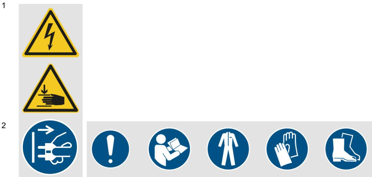
Abb. 1-1: Sicherheitskennzeichnungen: 1 - Warnzeichen: Warnung vor elektrischer Spannung, Warnung vor Handverletzungen | 2 - Gebotszeichen: Netzstecker ziehen, allgemeines Gebotszeichen, Anleitung beachten, Schutzkleidung benutzen, Handschutz benutzen, Fußschutz benutzen
