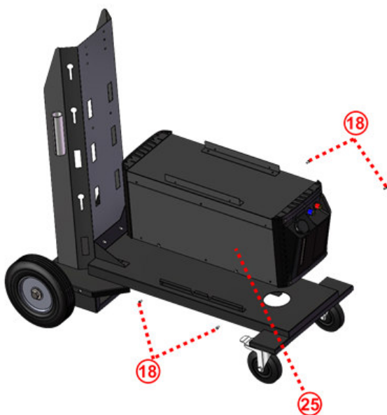
Abb. 9-6: Montage des Schweißgerätwagens Schritt 2, 3 & 4
