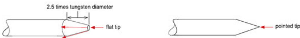
Abb. 11-10: Elektrodenspitze / Planfläche (Flat)
