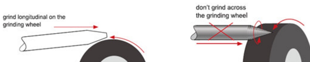
Abb. 11-9: Vorbereitung der Wolframelektrode
