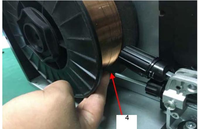
Abb. 41: Drahteinführung
