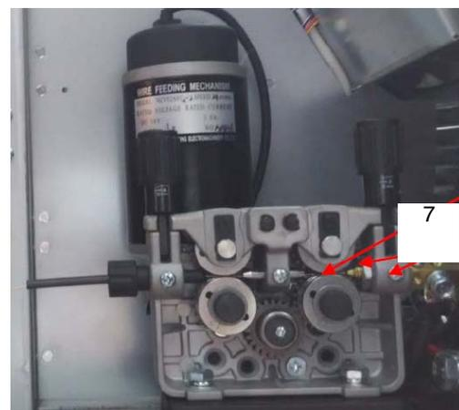
Abb. 53: Einstellung des Auslassrohrs
