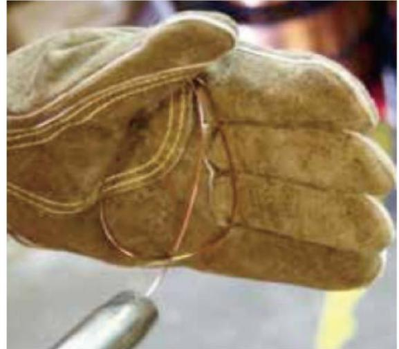
Abb. 45: Drahtvorschubtest
