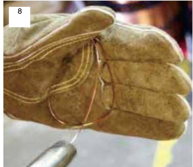
Abb. 54: Aufwickeln des Drahtes in der Hand
