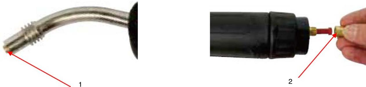
Abb. 67: Entfernung der Endteile und der Befestigungsmutter
