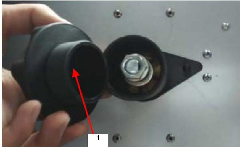
Abb. 47: Entfernung der Spulenhalmutter
