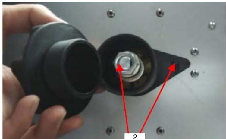
Abb. 48: Zugfedereinsteller und Spulenpositionierungsstift
