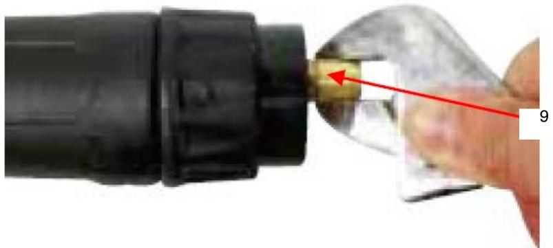
Abb. 64: Fest drehen der Befestigungsmutter des Einsatzes
