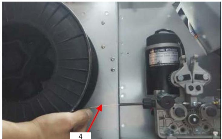
Abb. 50: Einführen des Drahts in das Führungsrohr
