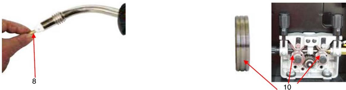
Abb. 70: Einsetzen des Spitzenhalters und der Antriebsrollen
