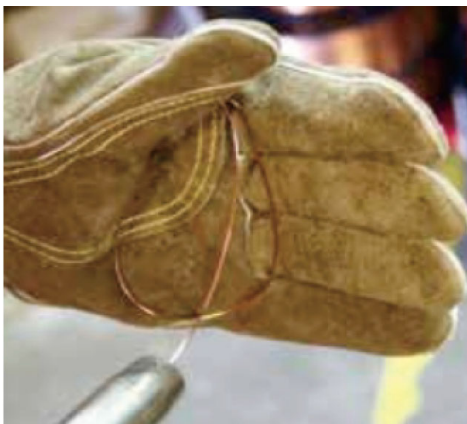
Abb. 52: Prüfen der Drahtspannung
