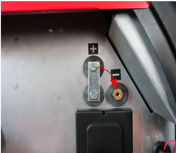
Abb. 55: Polarität des Brenners umstellen
