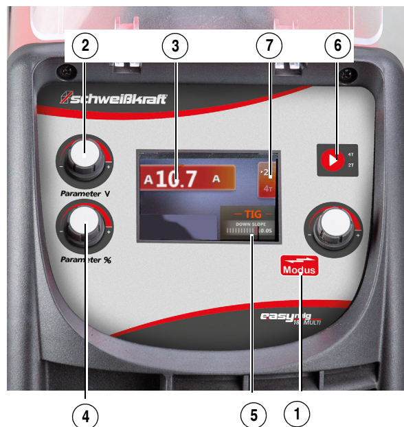
Abb. 12: Tasten des TIG-Schweißverfahrens
