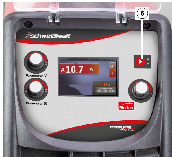
Abb. 20: Tasten des TIG-Schweißverfahrens
