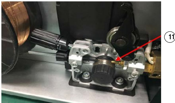
Abb. 39: Einführen des Drahts in die Zuführung
