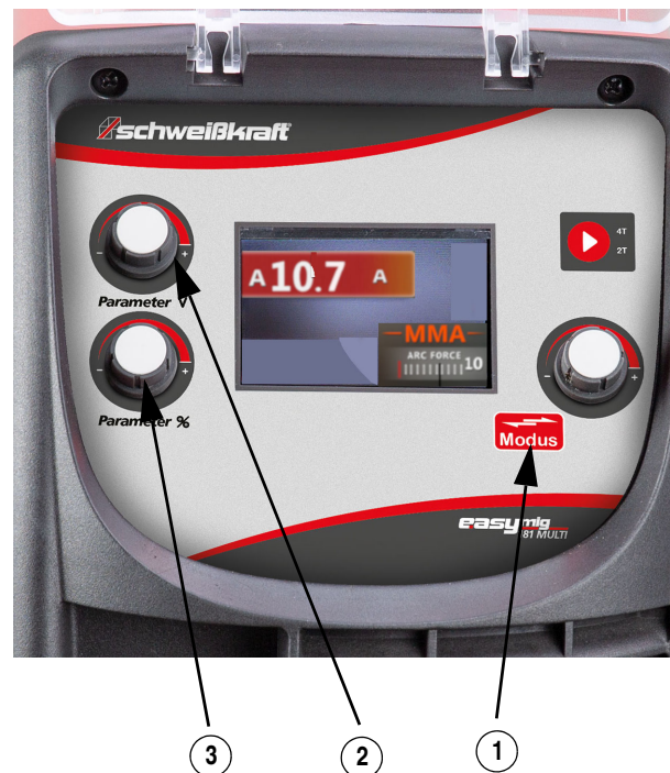
Abb. 14: Bedienung des MMA-Schweißverfahrens
