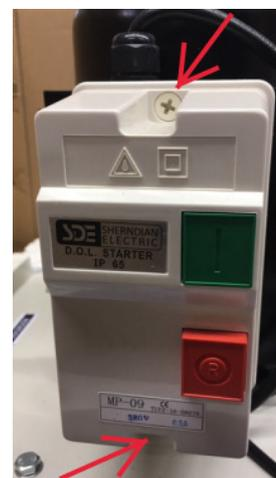
Abb. 2: Öffnen des Deckels
