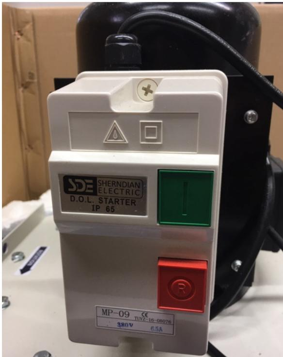
Abb. 1: Ansicht des Schutzschalters
